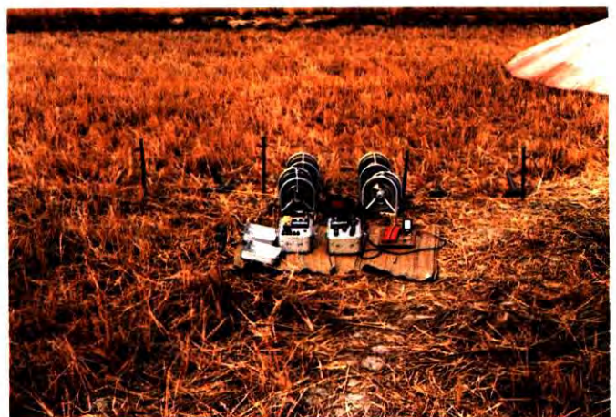
รูปแสดงการสำรวจด้วยวิธีวัดความต้านทานไฟฟ้า
