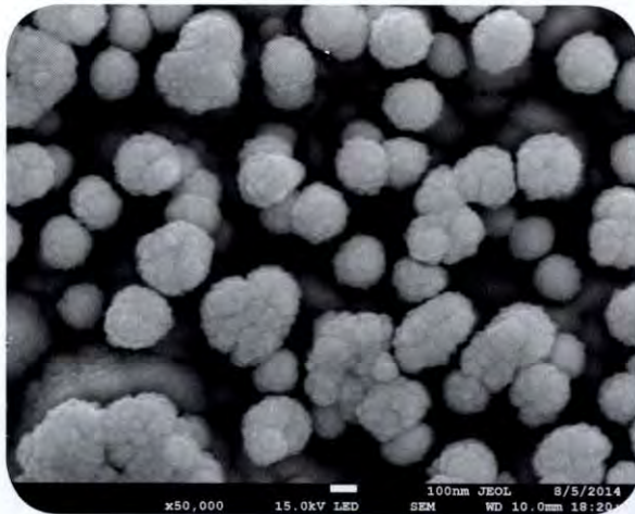
ภาพแสดงตัวอย่างของแผ่นไทเทเนียมที่มีการเคลือบด้วยสารแคลเซียมเหนียวนำเชิงชีวภาพ (ซ้าย) และภาพ SEM แสดงลักษณะของพื้นผิวของแผ่นไทเทเนียมดังกล่าวซึ่งมีความขรุขระเพื่อเพิ่มความสามารถในการยึดติดกับเนื้อเยื่อจริง (ขวา)
