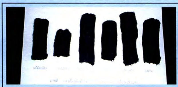
>>แท่นเชื้อเพลิงที่ได้จากการอัดรวัดดูติบร่วมกับเปลือกทุเรียนแห้ง<<
