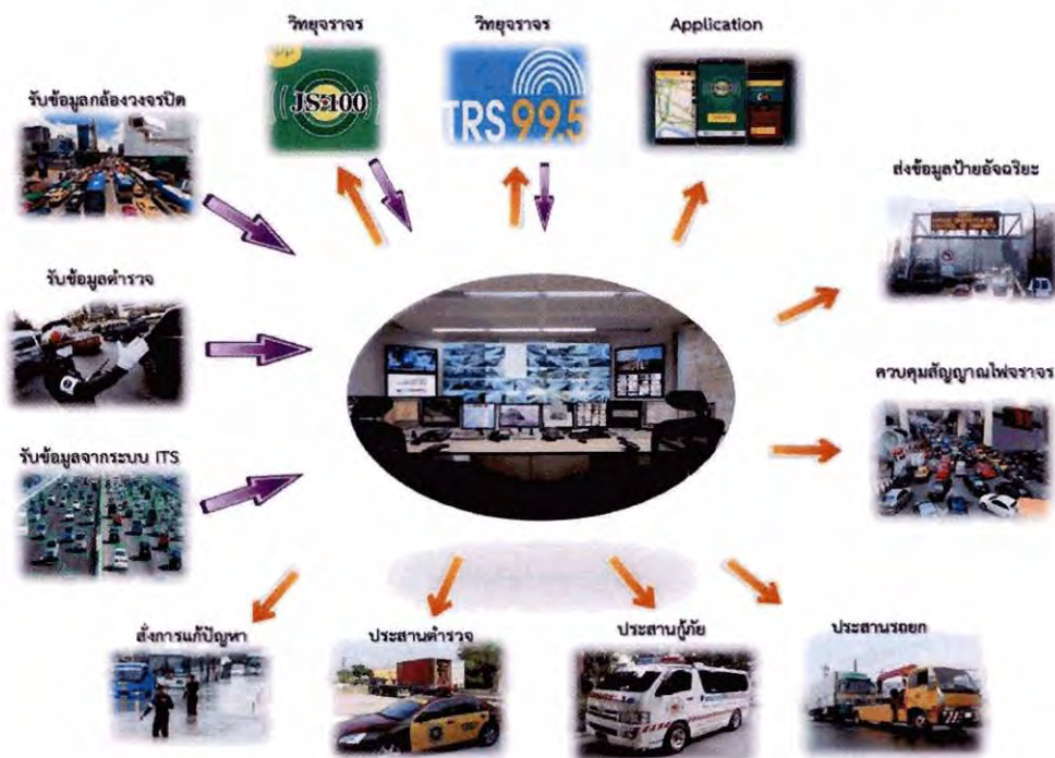
รูปที่ ๑๖ โครงสร้างศูนย์ประสานงานกลางเพื่อแก้ปัญหาจราจร (ศป.จร.) (Traffic Operation Center : TOC)
