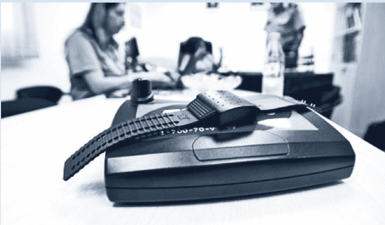
ภาพที่ ๒ : อุปกรณ์อิเล็กทรอนิกส์ที่ใช้ตรวจสอบหรือจำกัดการเดินทาง และอาณาเขตของผู้ถูกจำกัดที่สวมใส่ไว้ที่ข้อมือในประเทศอิสราเอล (electronic monitoring bracelets)
