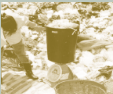
การหาความหนาแน่น (Bulk Density) ของตัวอย่างขยะมูลฝอย
