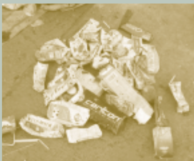
การหาความหนาแน่น (Bulk Density) ของตัวอย่างขยะมูลฝอย
