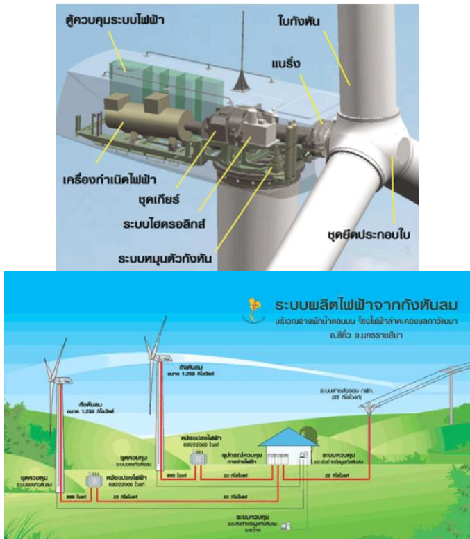
ภาพที่ ๒๙ กังหันลมกับการผลิตไฟฟ้า
