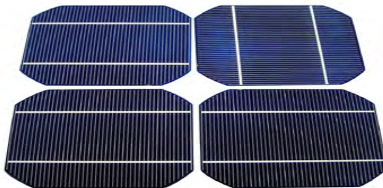
รูปที่ 2-16 ลักษณะของเซลล์แสงอาทิตย์แบบผลึก
