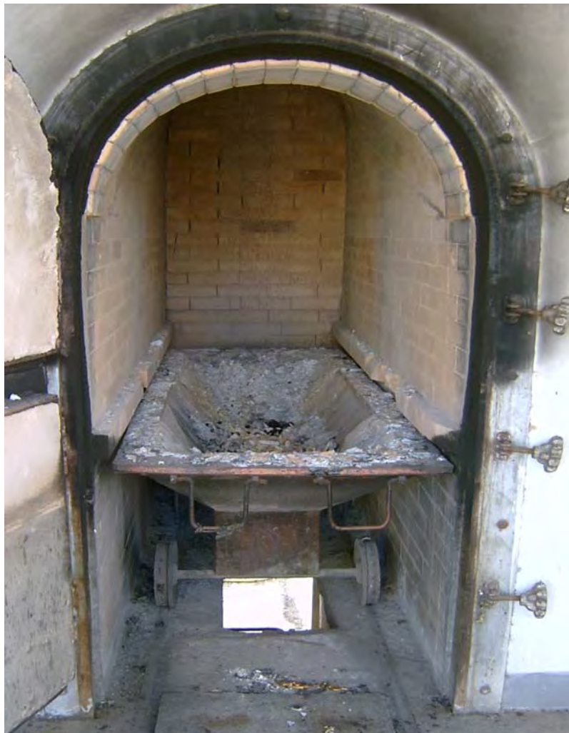
ลักษณะภายในของเตาเผาแบบห้องเดี่ยว และกระบะพร้อมรางเลื่อนสำหรับวางหีบบรรจุศพที่จะเผา
