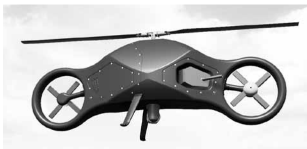
โครงการวิจัยและพัฒนา อากาศยานไร้คนขับแบบขึ้น-ลง ทางตั้ง
