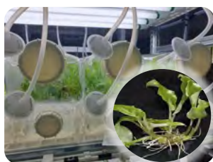
ระบบการเพาะเลี้ยงเนื้อเยื่อ โดยใช้ระบบไบโอรีแอคเตอร์
