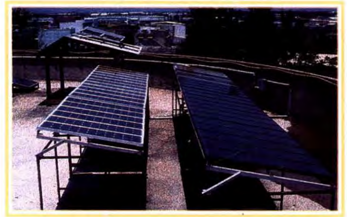
แทนทดสอบแผงโซลาร์เซลล์กลางแจ้ง ตามมาตรฐานอุตสาหกรรมของออสเตรเลีย อยู่ที่สถาบันเทคโนโลยีพระจอมเกล้าธนบุรี
