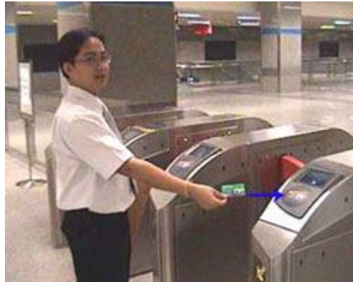
ภาพที่ 38 การอ่านบัตรในระยะ 1-5 เซนติเมตร
