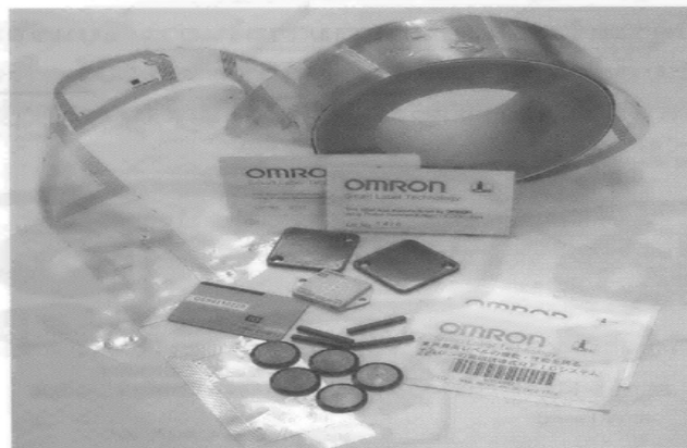
ภาพที่ 21 RFID แท็ก ชนิดต่างๆที่ออกแบบมาเพื่อตอบสนองทุกการใช้งาน
