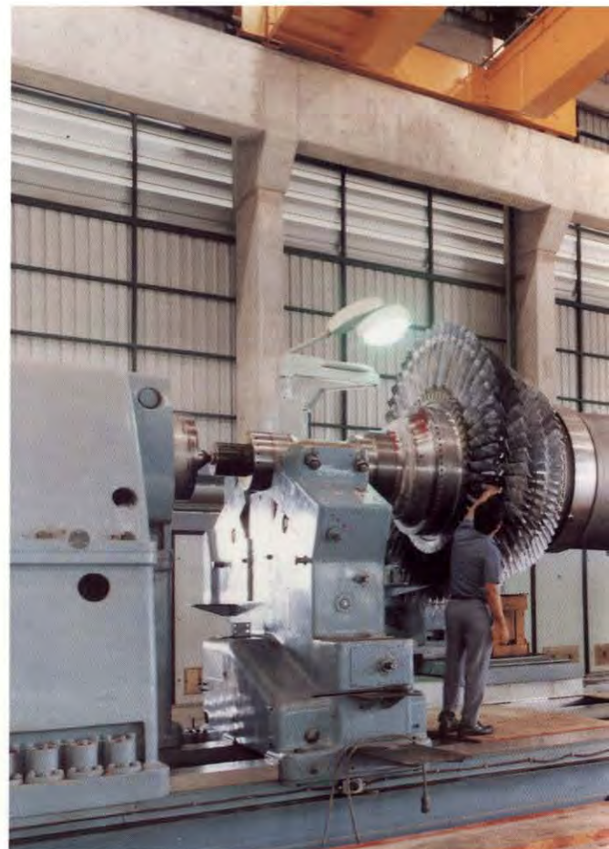
เครื่องกลึงขณะกลึงเครื่องกังหันไฟฟ้าขนาดเส้นผ่าศูนย์กลาง ๔ เมตร
