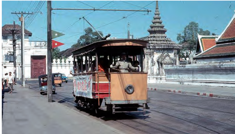
ป้ายสามเหลี่ยมสีแดงมีดาวตรงกลางคือจุดจอด ขึ้นลงและรับผู้โดยสาร....ส่วนป้ายสามเหลี่ยมสีเขียวมีดาวตรงกลางคือป้ายแสดงจุดให้รถรางรอหลีกเลี่ยงขบวนกัน
