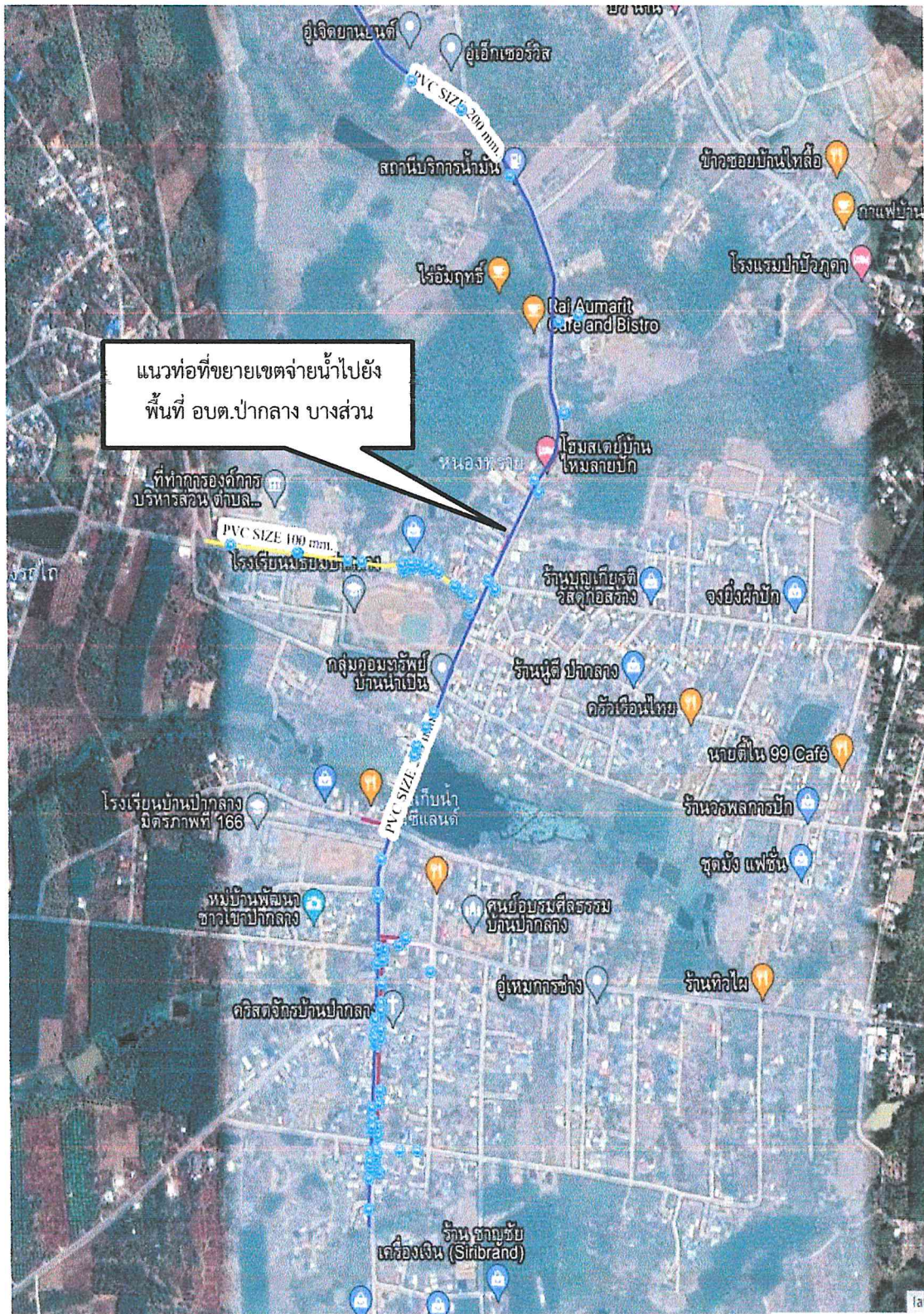
ภาพแสดง : แนวท่อประปาที่การประปาส่วนภูมิภาคขยายเขตจ่ายน้ำไปยัง อบต.ปากกลาง ในปัจจุบัน
