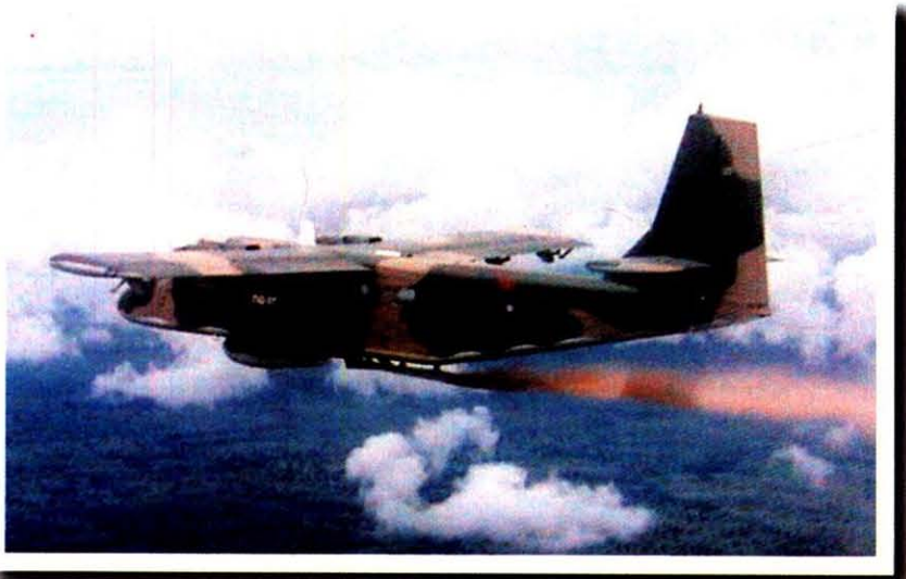
เครื่องบิน Nomad ปล่อยสารทำฝนหลวงจากเมฆอุ่น บินที่ความสูง 5000-8000 ฟุต
