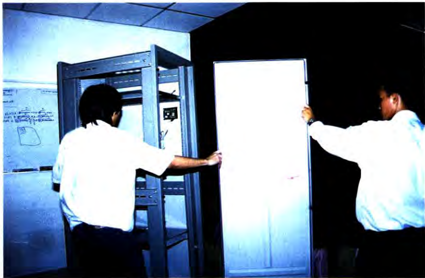
รูปที่ ๔ ขั้นตอนการประกอบฝาเข้ากับโครงตู้
