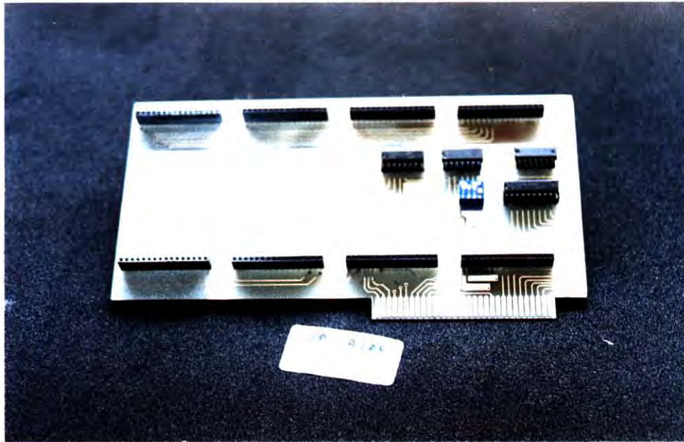
แผ่นการ์ดแปลงสัญญาณเป็นข้อมูล (Analog to Digital Converter) ที่ออกแบบให้กระทัดรัด ยืดหยุ่น กับการใช้งานและราคาถูก
