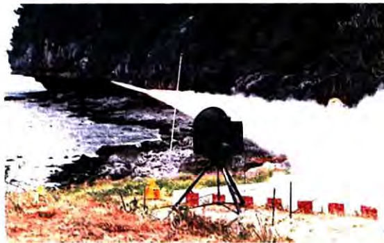
ภาพการทดสอบจรวดภาคพลวัตยิงจากพื้น-สู่-พื้นเพื่อดู Reliability ทำการทดสอบ ณ กองบิน ๕๓ กองพลบิน ๔ จ.ประจวบคีรีขันธ์
