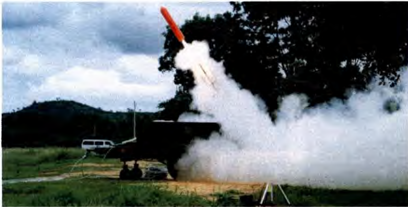
โครงการจรวดลากระเบิดสายสนับสนุนกรมการทหารช่าง กองทัพบก เป็นตัวอย่างการนำเทคโนโลยีการผลิตดินขับจรวด Composite มาประยุกต์ใช้
