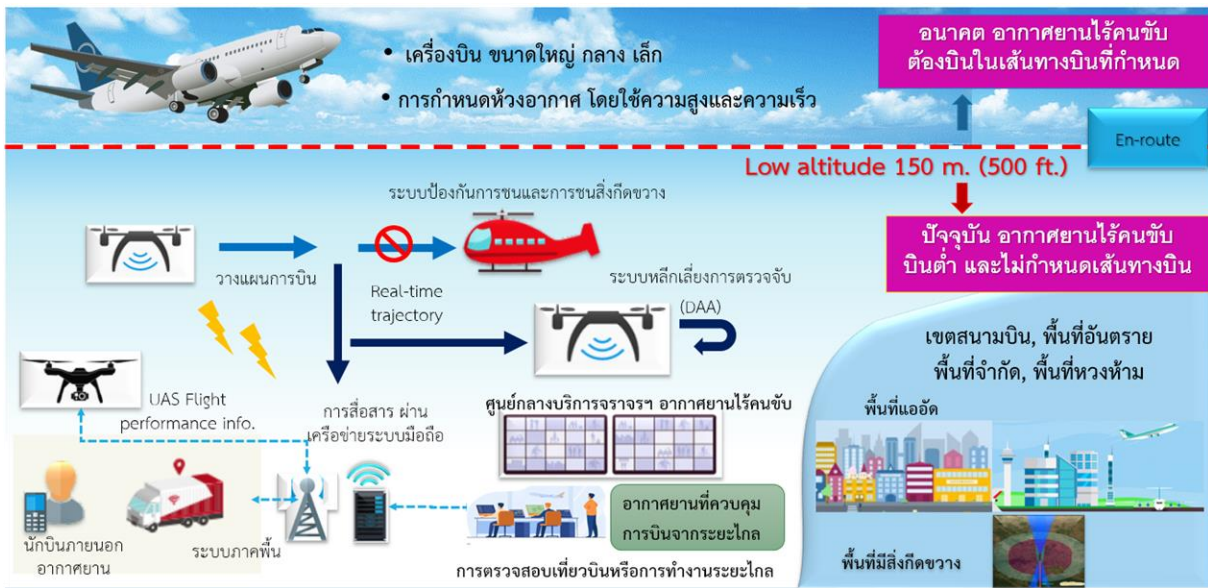
ภาพที่ ๓.๑ (๒) การกำหนดแผนผังกรอบความคิดของการปฏิบัติการบิน โดยการจัดห้วงอากาศของอากาศยานไร้คนขับแยกจากอากาศยานที่มีคนขับ
