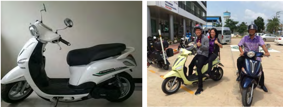
รูปที่ 2-14 ต้นแบบของจักรยานยนต์ไฟฟ้าที่ใช้มอเตอร์ไฟฟ้าชนิดสวิตช์รีลักแทนซ์มอเตอร์
