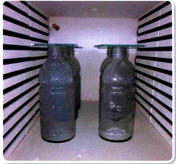
■ การทดลองเพิ่มความทนทานต่อการกัดกร่อนผิวภายในขวดแก้วสำหรับเครื่องดื่ม
