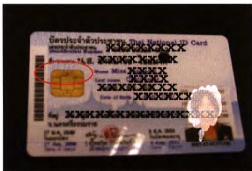
รูปที่ 3 บัตรที่พิมพ์หน้าบัตรเกือบสมบูรณ์แต่ IC CHIP นูน จึงพิมพ์ ชื่อ - สกุล ไม่ติด และไม่เคลือบสีง้ำ
