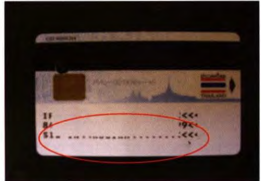
รูปที่ 4 บัตรที่พิมพ์หลังบัตรไม่สมบูรณ์
