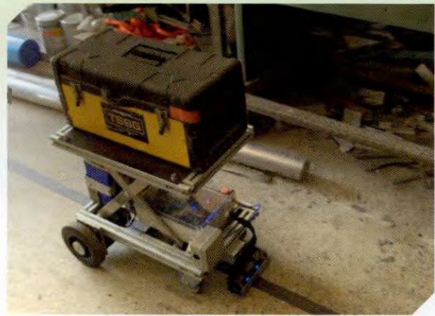
รูปแสดงหุ่นยนต์สามแกนสำหรับจัดเก็บและดวงสารเคมี (ซ้าย) หุ่นยนต์ขนส่งวัสดุวิ่งตามแถบแม่เหล็ก (AGV) (ขวา)
