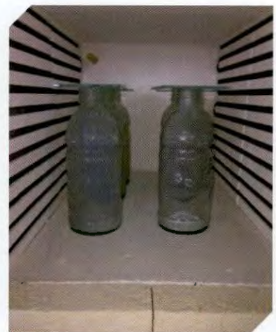
ภาพการทดลองการเพิ่มความทนทานต่อการกัดกร่อนผิวภายในขวดแก้วสำหรับเครื่องดื่ม
