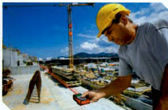
ภาพที่ 2 การใช้งานเครื่องวัดระยะชนิดเลเซอร์ (Laser distance meter) และ EDM
