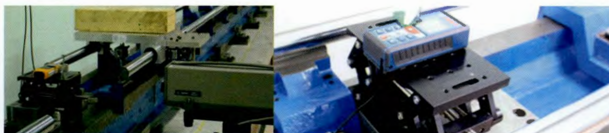
ภาพที่ 3 การสอบเทียบเครื่องวัดระยะชนิดเลเซอร์ด้วยเลเซอร์อินเตอร์เฟียรอมิเตอร์
