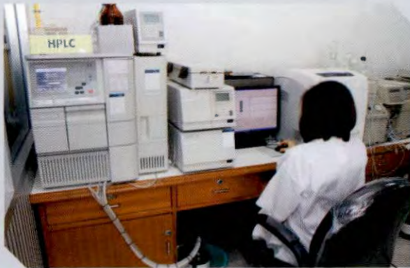
การทดสอบการแพร่กระจายของสารเมลามีน โดยเครื่องไฮเพอร์ฟอร์แมนซ์ลิควิดโครมาโทกราฟี
