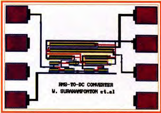
สวดลาย (layout) ของวงจรเปลี่ยนค่ารากกำลังสองเฉลี่ยของสัญญาณเป็นค่าศักย์ดีซี
