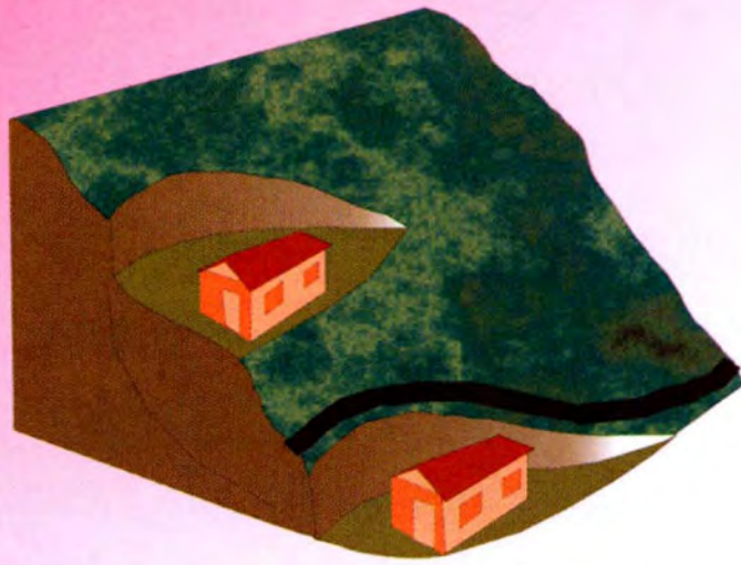
รูปที่ 16 การตัดไหล่เขาเพื่อปลูกสร้างบ้านซึ่งเป็นสาเหตุหลักที่ทำให้เกิดดินไหล
