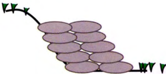
รูปที่ 18 การประยุกต์ใช้กระสอบทรายเพื่อใช้เป็นผนังกันดิน
