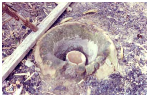
ภาพที่ 4.7 เตาหลอมทองเหลืองแบบดั้งเดิมของชุมชนหัตถกรรมบ้านปะอาว อำเภอเมือง จังหวัดอุบลราชธานี ประกอบด้วยส่วนตัววงเตาและมีเบ้าหลอมทำด้วยดินเผาวางในเตา เป็นไปได้ว่าเตาหลอมทองแดงยุคก่อนประวัติศาสตร์ที่โนนป่าหวายคงมีลักษณะเช่นนี้ ในขณะทำการถลุงทองแดง
