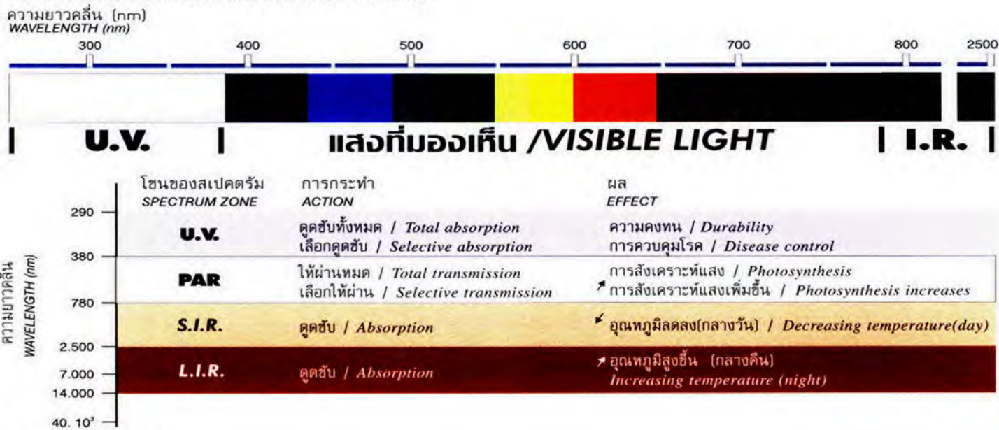
กราฟที่ 2.3/GRAPH 2.3: ผลที่สเปกตรัมของรังสีแสงอาทิตย์มีต่อพืช SUN RADIATION SPECTRUM AND EFFECT ON THE CROP
