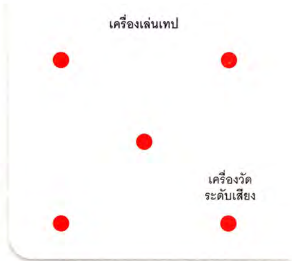
แผนผังแสดงจุดตรวจวัดระดับเสียงในห้องเรียน
