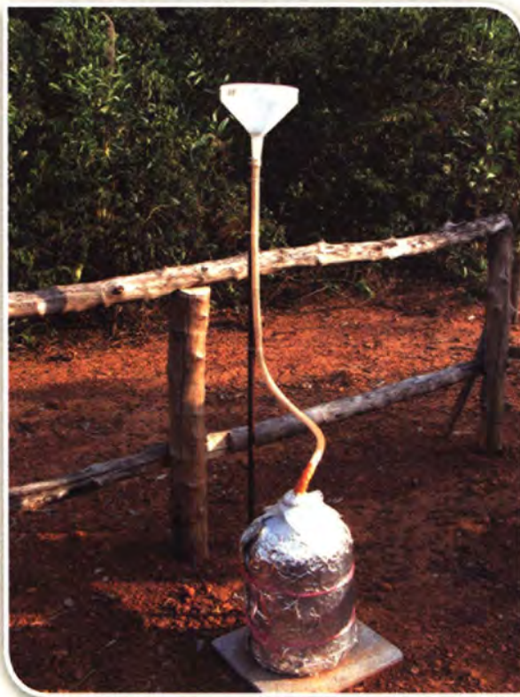
อุปกรณ์เก็บตัวอย่างน้ำฝนกลางแจ้ง
