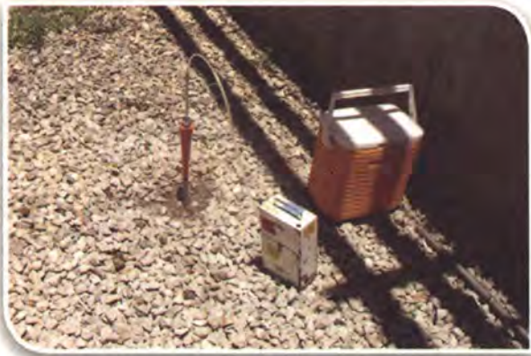
เก็บตัวอย่าง soil gas เพื่อวิเคราะห์หาปริมาณสารอินทรีย์ระเหย
