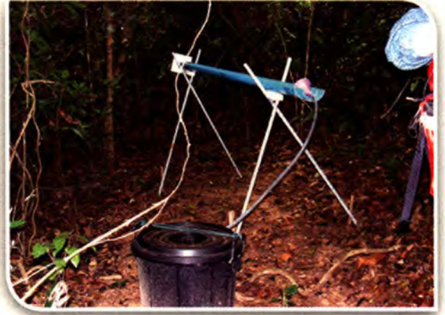
อุปกรณ์เก็บน้ำฝนที่ตกผ่านต้นไม้
