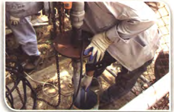
วัดความลึกของบ่อและวัดระดับน้ำ
