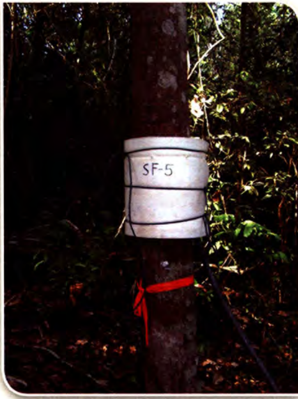
อุปกรณ์เก็บตัวอย่างน้ำฝนที่ตกผ่านต้นไม้
