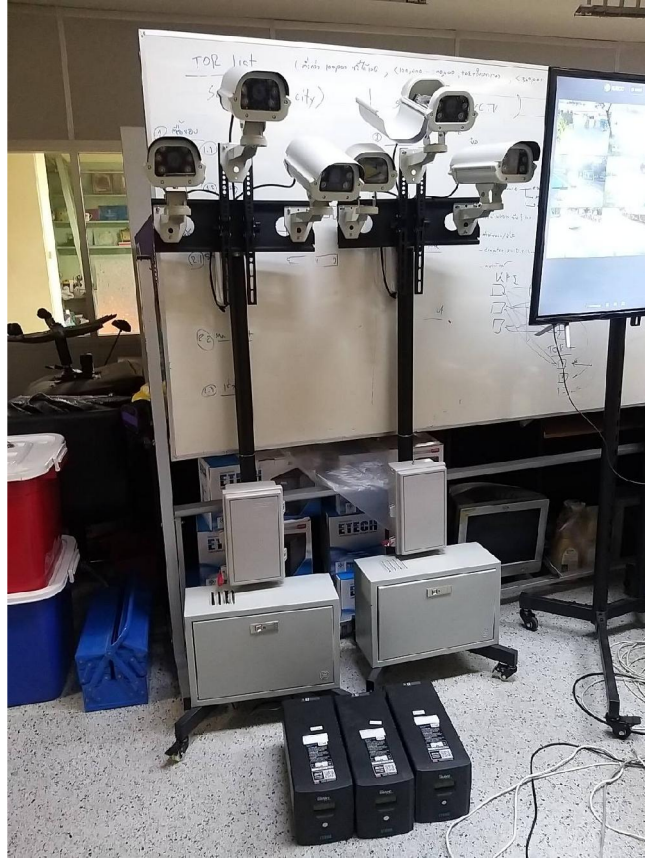
ภาพที่ ๕๖ ระบบควบคุมสัญญาณไฟจราจรอัตโนมัติโดยใช้เทคนิคประมวลผลภาพ (CCTV + AI Box) แบบเคลื่อนที่ได้ สามารถนำไปใช้สำหรับแยกวัดใจในพื้นที่ท้องถนนหรือเทศบาล เพื่อช่วยในการจัดการจราจรและความปลอดภัยในการเดินทางได้
