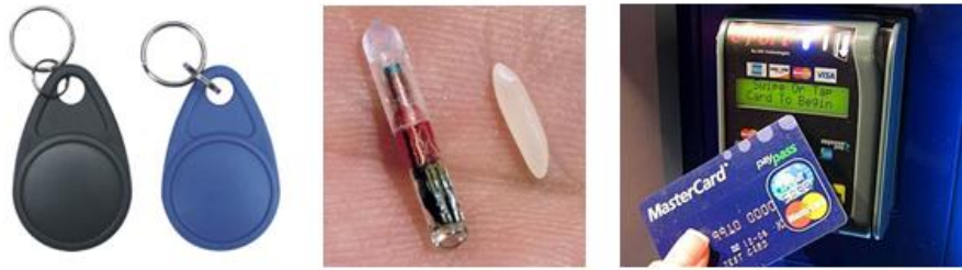
ภาพที่ ๔๗ ตัวอย่าง Tag ชนิดพวงกุญแจ แคมปูล และบัตรตามลำดับ
