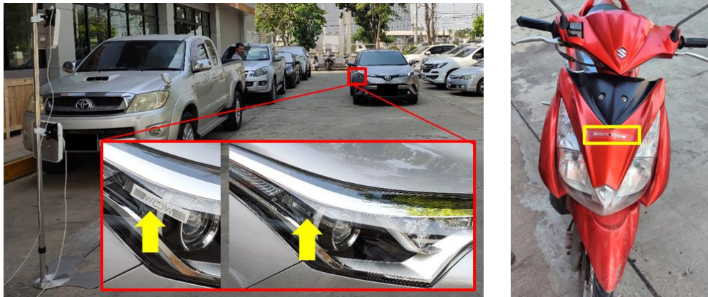
ภาพที่ ๕๐ ตัวอย่างแท็กติดไฟหน้ารถยนต์และมอเตอร์ไซด์
