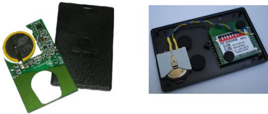
ภาพที่ ๔๘ ตัวอย่าง Tag บัตรภายในบรรจุแบตเตอรี่ขนาดเล็กไว้
