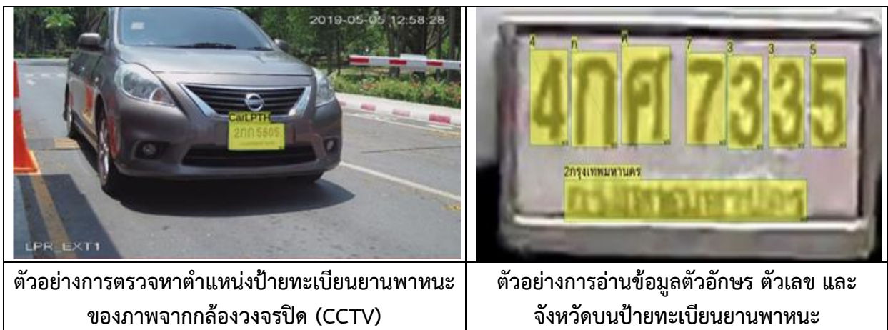
ภาพที่ ๓๙ ตัวอย่างการตรวจหาตำแหน่งป้ายทะเบียนและการอ่านข้อมูลตัวอักษร-ตัวเลข
