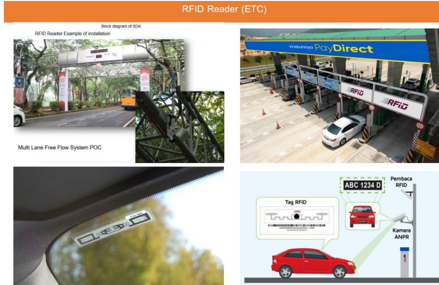
ภาพที่ ๔๔ ตัวอย่างของ Toll Tag (Vehicle Re-Identification) RFID
