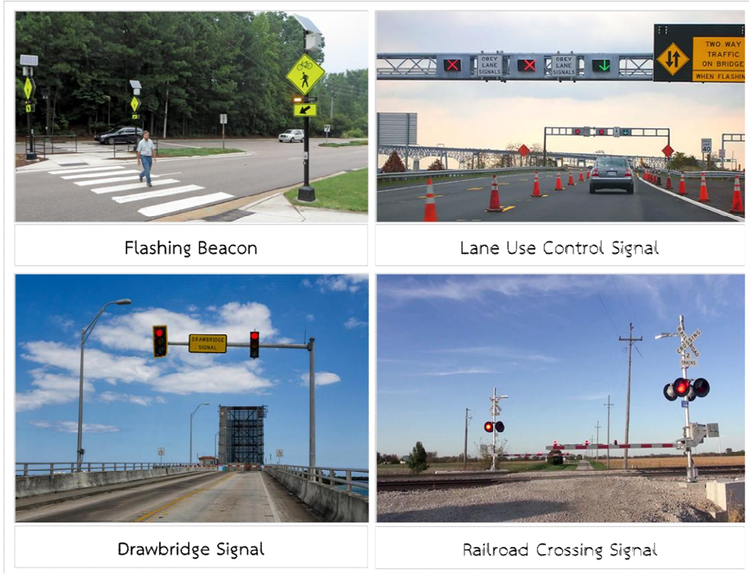
ภาพที่ ๕๔ สัญญาณไฟสำหรับกรณีพิเศษ (Special Traffic Signal)
