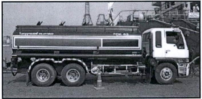
รถบรรทุกรับของเสียปนน้ำมัน ขนาด 15 ลบ.ม.
