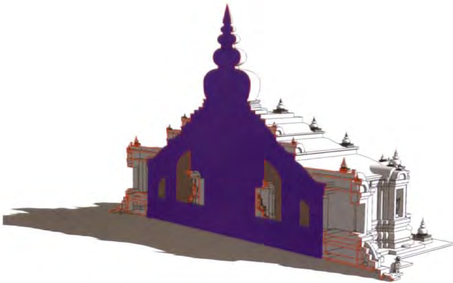
ภาพที่ ๕ รูปตัดสันนิษฐานเจดีย์วัดพระเมรุ โครงสร้าง แกนกลาง เพดานระเบียงคต และยอดเป็นทรงหม้อน้ำ
