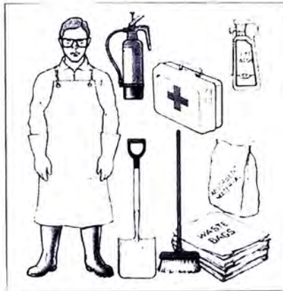
ยานพาหนะควรมีอุปกรณ์ดับเพลิง ชุดป้องกัน กล่องเครื่องมือปฐมพยาบาลและอุปกรณ์ทำความสะอาดไปด้วย
