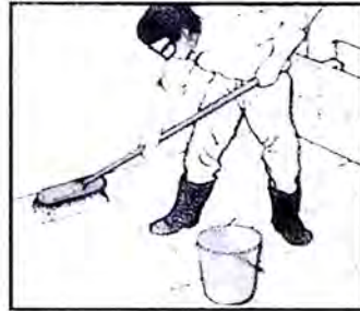
ใช้น้ำทำความสะอาดส่วนที่เป็นเบ้าของตู้สินค้า
