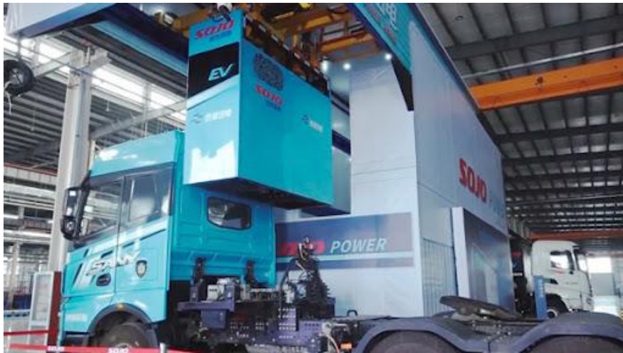
ภาพที่ ๒๗ ระบบการเปลี่ยนแบตเตอรี่ (battery swapping systems)
