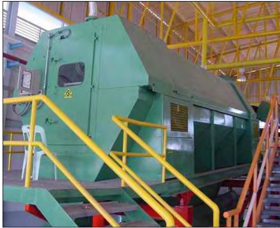
ภาพที่ 2.6 ตะแกรงคัดแยกขยะ แบบ Drum Screen ที่มา: โรงผลิตปุ๋ยอินทรีย์และพลังงาน เทศบาลนครระยอง
