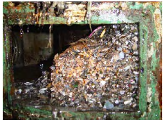
เครื่องบดย่อยเดิมซึ่งไม่สามารถแยกส่วนที่มีน้ำหนักมากออกได้
