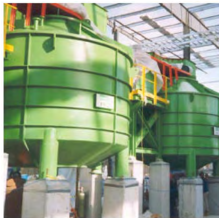
ภาพที่ 2.5 Hydro Pulper อุปกรณ์สำหรับการคัดแยกขยะแบบ Wet Separation Process
