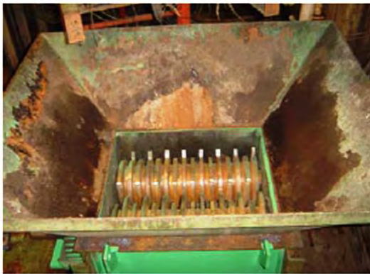
เครื่องบดย่อยเดิมซึ่งไม่สามารถแยกส่วนที่มีน้ำหนักมากออกได้
