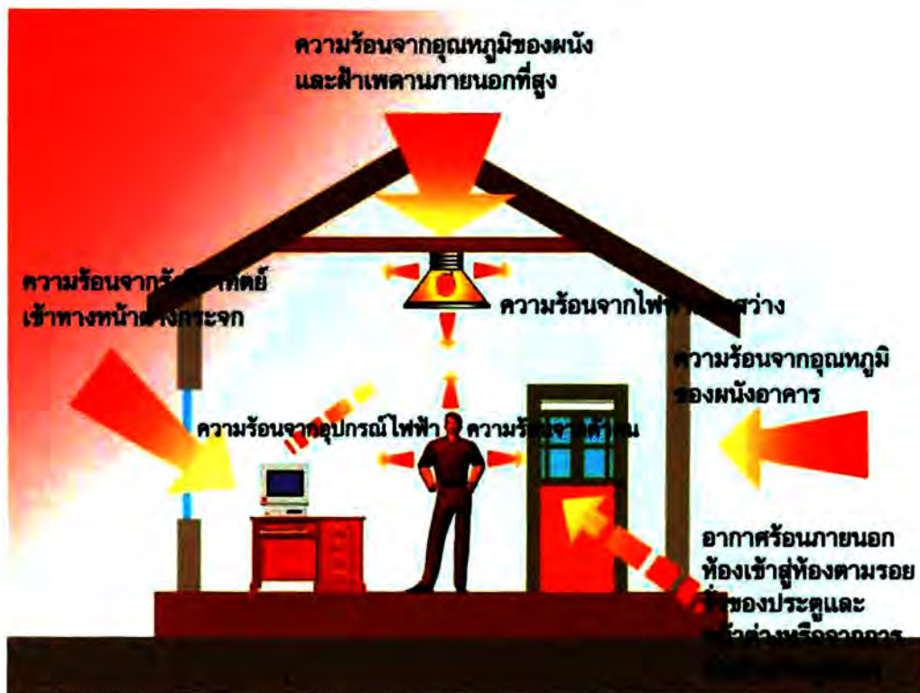
ภาพที่ 19 แหล่งที่มาของความร้อนภายในอาคาร ซึ่งแบ่งออกเป็น 2 ประเภท ได้แก่ ความร้อนจากภายนอกอาคารและความร้อนจากภายในอาคาร
