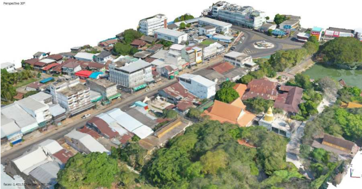
รูปที่ 6 - 8 ข้อมูลแบบจำลองสามมิติ (Mesh Model) การสำรวจและสร้างแบบจำลองสามมิติ บริเวณชุมชนเมืองเก่า จังหวัดสุรินทร์
