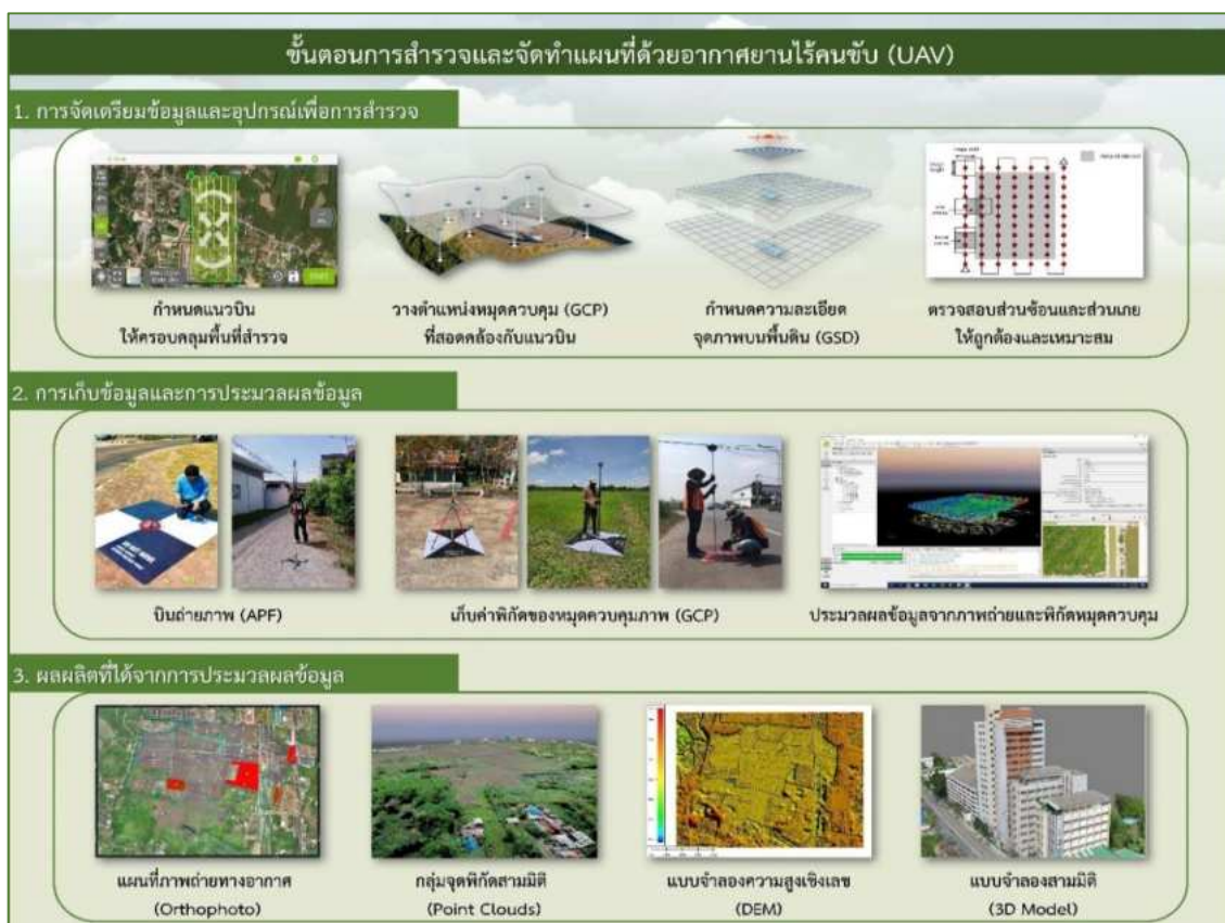
รูปที่ 6 - 1 ขั้นตอนการสำรวจภาพถ่ายทางอากาศด้วยอากาศยานไร้คนขับ (UAV)
