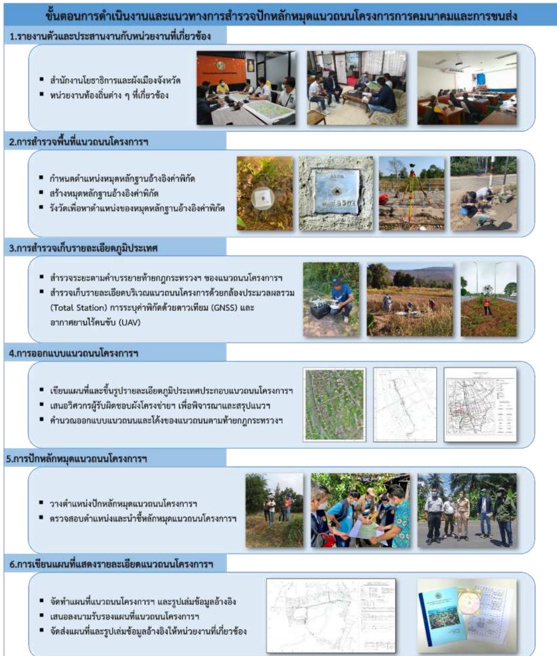
รูปที่ 6 - 15 ขั้นตอนการดำเนินงานและแนวทางการสำรวจปักหลักหมุดแนวถนนโครงการการคมนาคมและการขนส่ง
