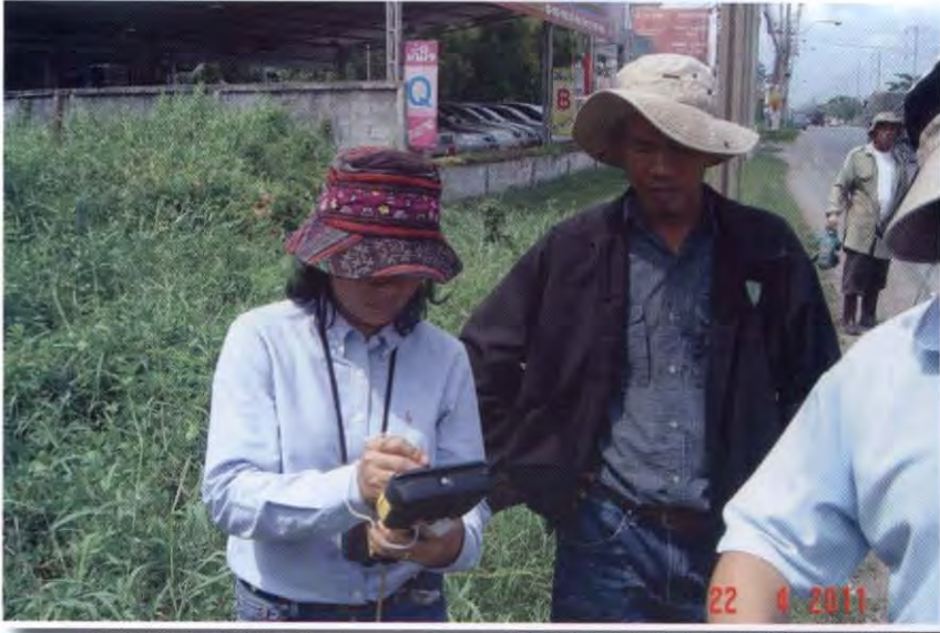
ภาพที่ ๓ แสดงการปฏิบัติงานรังวัดด้วยเครื่องรับสัญญาณดาวเทียม (Rover) กับระบบโครงข่ายฯ
