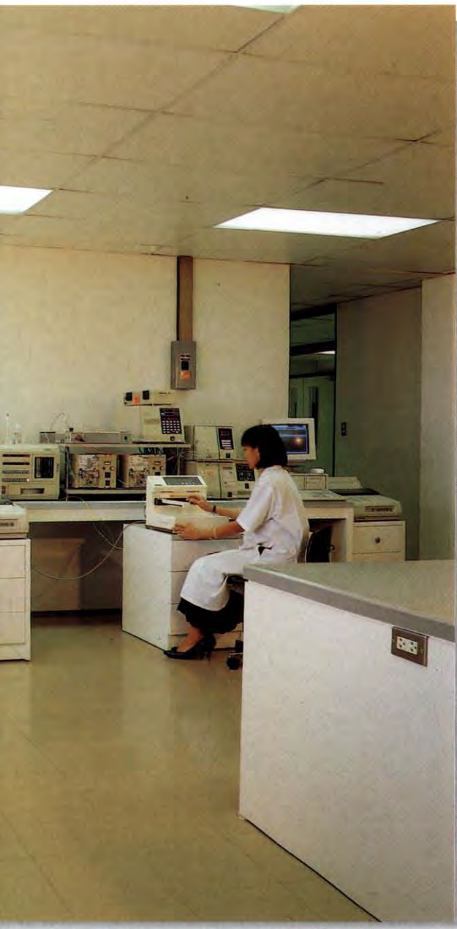
ห้องปฏิบัติการเครื่องมือรวมแสดงเครื่อง High Performance Liquid Chromatography (HPLC) สำหรับแยกชนิดสารและตรวจวิเคราะห์ปริมาณสารเคมี รวมทั้งศึกษาคุณสมบัติของสารเคมี
