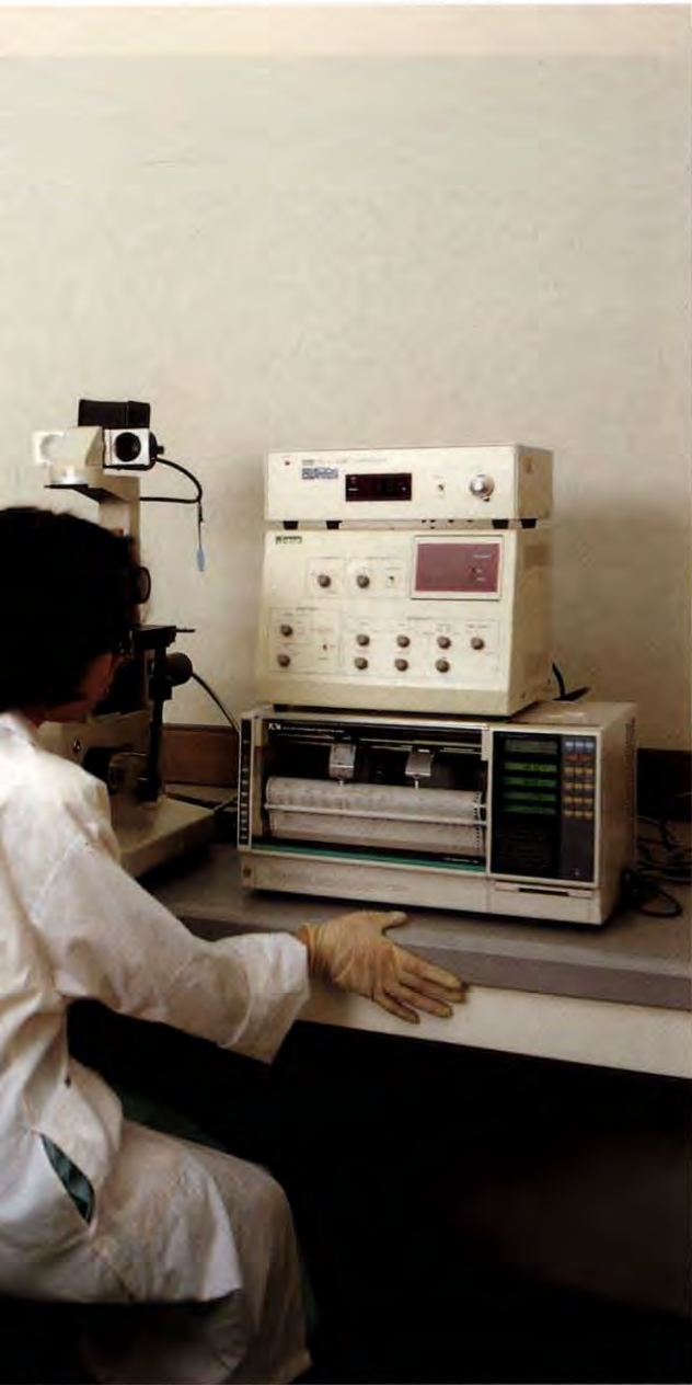
ห้องปฏิบัติการพยาธิชีววิทยา ในภาพเป็นเครื่อง Calcium Analyzer สำหรับวัดระดับของอนุคลอสิสระแคลเซียมในเซลล์
