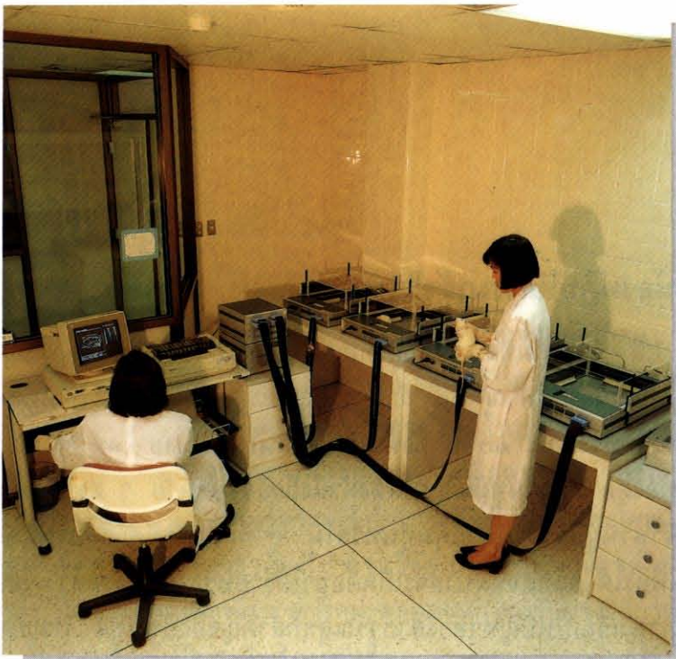
เครื่อง Opto-Varimex Autotrack System สำหรับวัดพฤติกรรมเคลื่อนไหวของสัตว์ทดลอง
