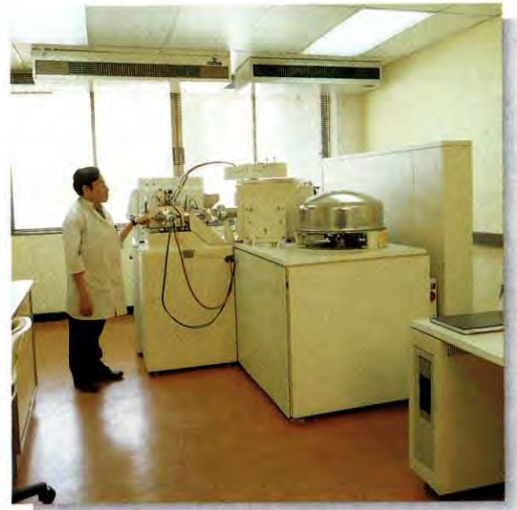
ห้องปฏิบัติการทางเคมี แสดงเครื่อง Mass Spectrometer (MS) สำหรับศึกษาหามวลโมเลกุล และโครงสร้างของสารเคมี
