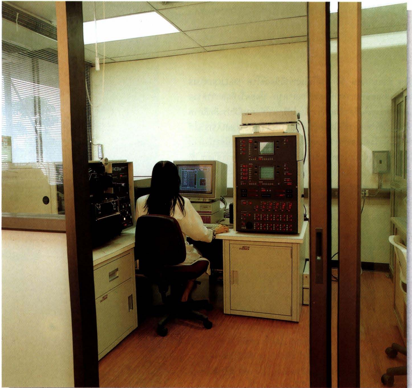
เครื่อง Fluorescence Activated Cell Sorter (FAC Star Plus) ใช้แยกชนิดของเซลล์จำเพาะออกจากกลุ่มเซลล์รวม เช่น ใช้ในการค้นหาและแยกเซลล์มะเร็งออกจากเซลล์ปกติ
