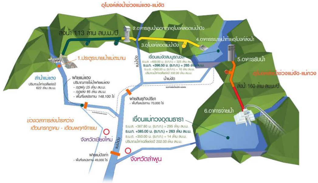
ภาพที่ 2 แสดงโครงการเพิ่มปริมาณน้ำในอ่างเก็บน้ำเขื่อนแม่กวางอุดมธารา จังหวัดเชียงใหม่ ที่มา: ข้อมูลโครงการเพิ่มปริมาณน้ำในอ่างเก็บน้ำเขื่อนแม่กวางอุดมธารา โดย กรมชลประทาน สำนักบริหารโครงการ ส่วนสิ่งแวดล้อม, ม.ป.ป., สืบค้นจาก http://eimp.rid.go.th/maekuang/ข้อมูลโครงการ/
