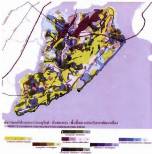
รูปที่ ๑๑ ผังรวมองค์ประกอบที่เกิดจากผลการวิเคราะห์-สังเคราะห์และประเมินข้อมูลเชิงพื้นที่ทุกด้าน โดยวิธีทับซ้อน (Overlay) ของแม็กฮาร์กที่บ่งชี้ความเหมาะสมของพื้นที่สำหรับการพัฒนา ซึ่งนักวางผังภาคจะนำไปใช้เป็นข้อมูลสำคัญในการวางผังการใช้ที่ดิน ปัจจุบันระบบภูมิศาสตร์สารสนเทศ (GIS) สามารถทำได้รวดเร็ว พื้นที่ที่เหมาะสมกับการพัฒนาเป็นเมือง คือ บริเวณสีม่วงแดง (ภาพจาก: Design With Nature, Ian McHarg)
