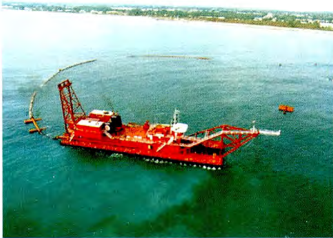
รูปที่ 3-14 เรือดูดทราย กำลังทำการดูดทรายใกล้ชายฝั่งซึ่งในโครงการต้องใช้ปริมาณของทรายประมาณ 783,000 ลูกบาศก์หลา (ปี 1998)
