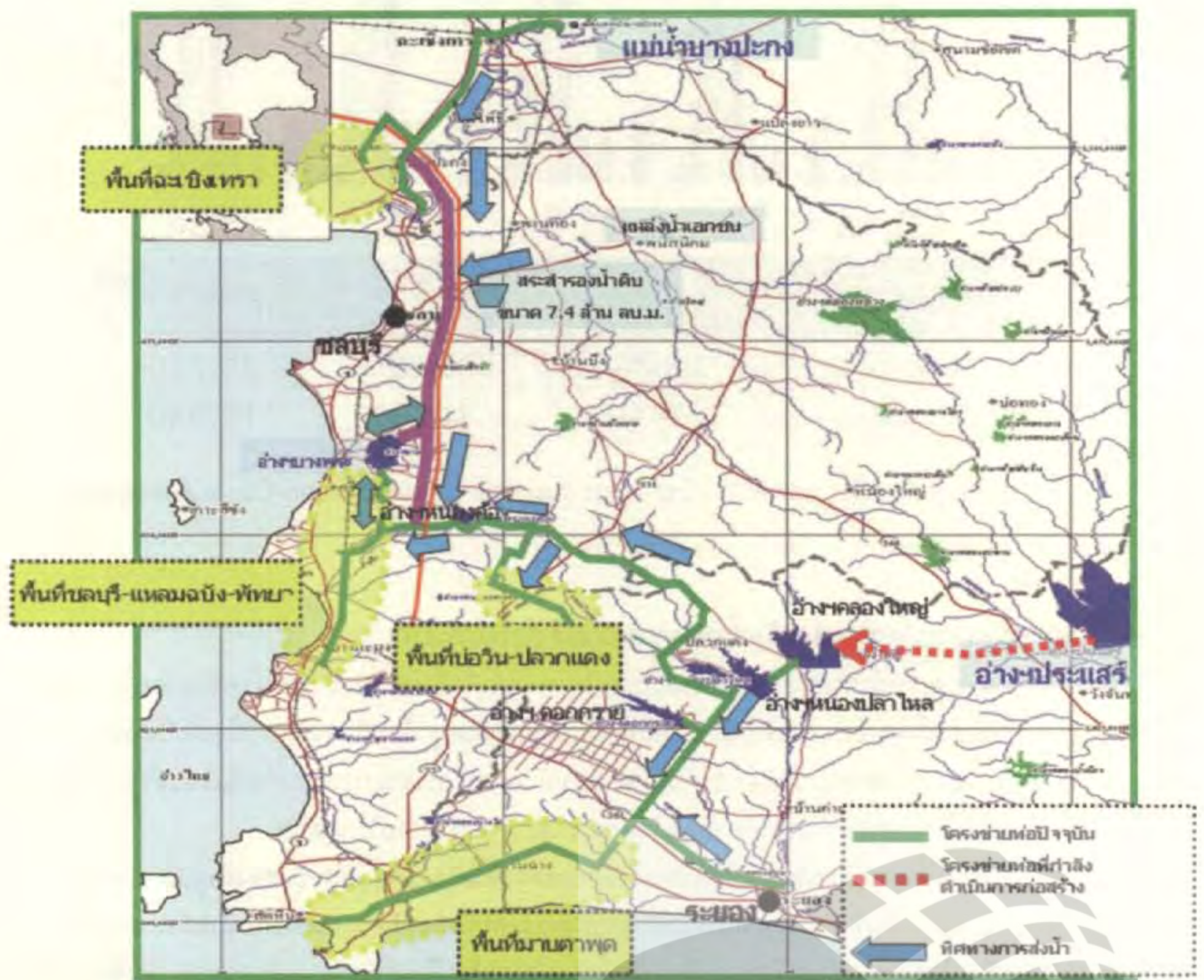
รูปที่ ๑.๒๕๕ ระบบส่งน้ำดิบพื้นที่ระยอง-ชลบุรี-ฉะเชิงเทรา (ที่มา: บริษัทจัดการและพัฒนาทรัพยากรน้ำภาคตะวันออกจำกัด (มหาชน), ๒๕๕๑)
