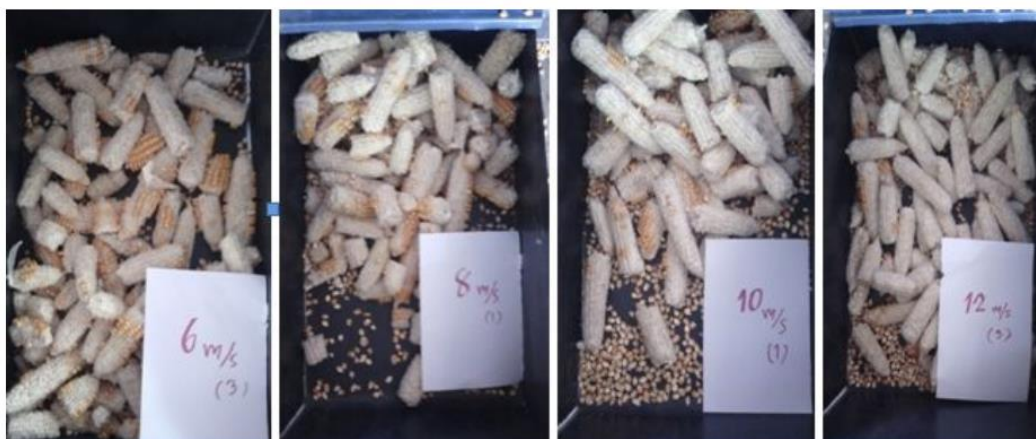
ภาพที่ 5 เครื่องกะเทาะข้าวโพดเลี้ยงสัตว์และผลการทดสอบกับข้าวโพดเลี้ยงสัตว์
